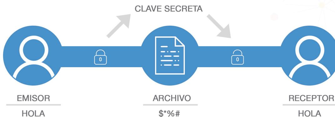
Utiliza una misma clave para cifrar y descifrar los datos. Es la más insegura ya que la comunicación de la clave entre el emisor y el receptor es fácil de interceptar.
